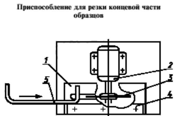
1 — стол; 2 — электродвигатель мощностью 300 Вт; 3 — отрезной диск на специальной бакелитовой основе (электрокорунд белый); 4 — упор; 5 — образец проволоки
