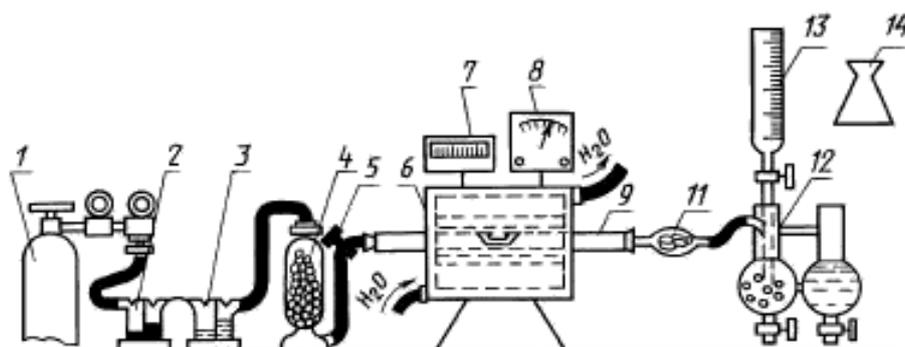
Установка для определения содержания серы состоит из следующих элементов: баллона с кислородом 1, снабженного редукционным вентилем для пуска и регулирования тока кислорода; склянки Тищенко 2, содержащей раствор марганцовокислого калия в растворе 300 г/дм<sup>3</sup> гидроокиси
